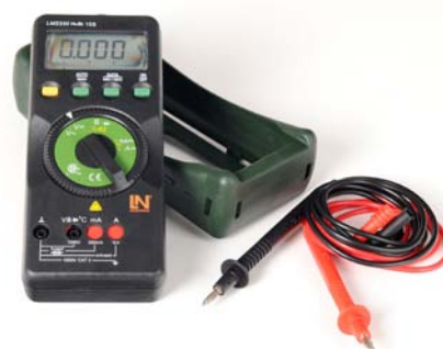
Cyfrowy miernik uniwersalny z interfejsem do wyświetlania danych za pomocą przyrządu wirtualnego na komputerze
